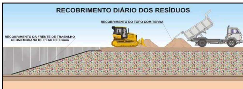
Figura 37 – Exemplo de recobrimento diários dos resíduos.
