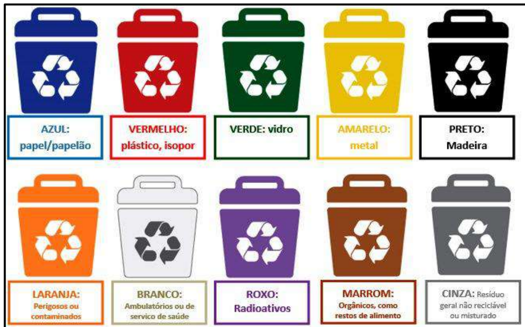
Figura 23 – Código de cores para os diferentes tipos de resíduos conforme Resolução CONAMA nº 275/2001.
