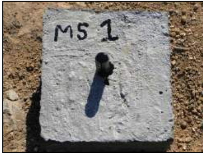
Figura 36 – Modelo de marco superficial que poderá ser implantado no aterro.
