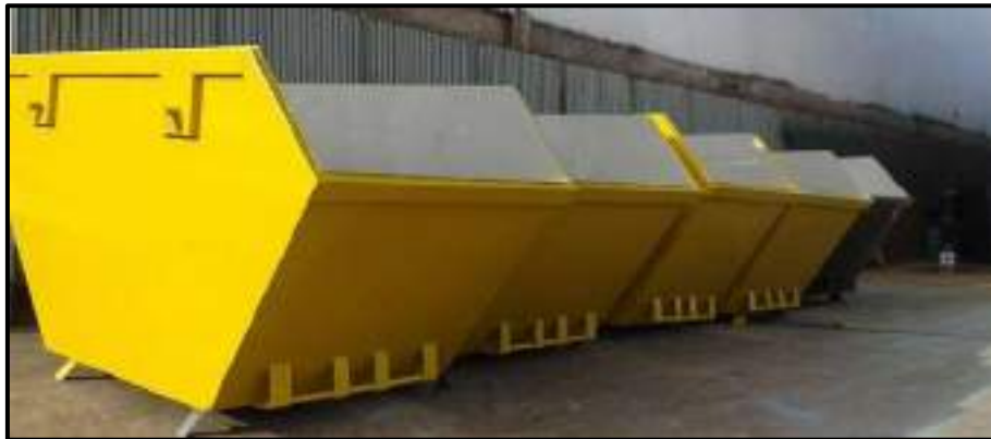
Figura 21 – Exemplo de caçambas estacionárias para armazenamento e transporte de resíduos da construção civil.
